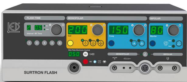
Surtron 200 Flash es un electrobisturí apto para intervenciones de microcirugía y cirugía de precisión monopolar y bipolar. Surtron 200 Flash permite efectuar tratamientos quirúrgicos con tiempos operativos programables en valores millesimales de segundo o puede operar con modalidad tradicional.
